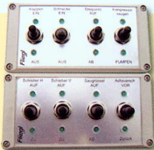
Jednoduché řízení palubní hydrauliky z traktoru.
