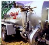
elektromagnetický řídicí blok k jednodušší obsluze hydraulických funkcí.
