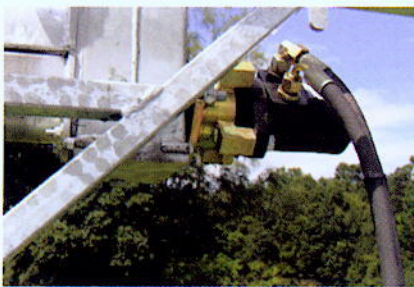
Olejový motor pro šnekový rozdělovač.
