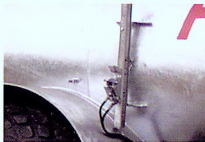
Přepravní jištění ramen pro silniční provoz, blokováno hydraulickými rozvody.
